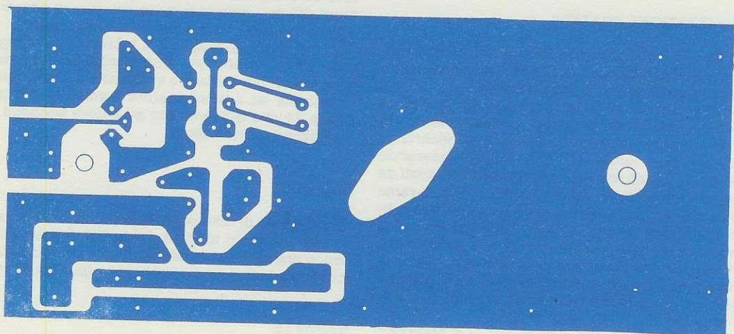
Fig. 2 Il circuito stampato necessario per la realizzazione dell'LX 493 è una doppia faccia. Nel disegno riportato sopra possiamo vederne il lato inferiore, mentre nella fig. 3 è visibile il lato superiore.
